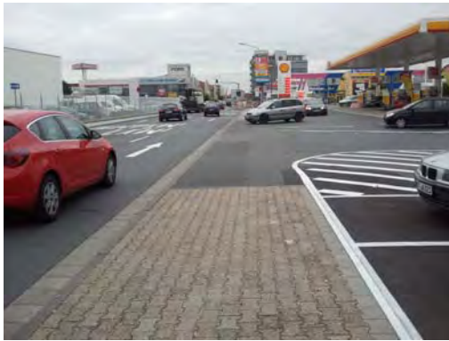
Abbildung 27: R.-Koch-Straße (Mangel 17) Abbildung 28: Gutenbergstraße (Mangel 19) Breite, stark frequentierte Grundstückszufahrten, Gefährdung des Rad- und Fußgängerverkehrs da deren Vorrang häufig durch Kfz-Verkehr missachtet wird
